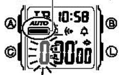
1. Нажмите и удержите кнопку «А» в режиме Таймера. Значение часов мигает на дисплее, так как оно выбрано для установки.
