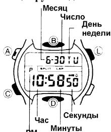
На рис.1., изображен общий вид часов в режиме Текущего времени. Для выбора формата представления времени (12/24 часовой) используйте кнопку D.
