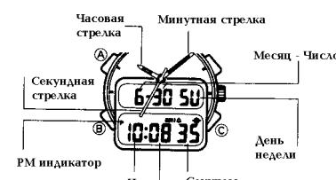
На рис.1., изображен общий вид часов в режиме текущего времени. Кнопка В осуществляет переход между режимами часов. Переход между режимами осуществляется в следующей последовательности:
